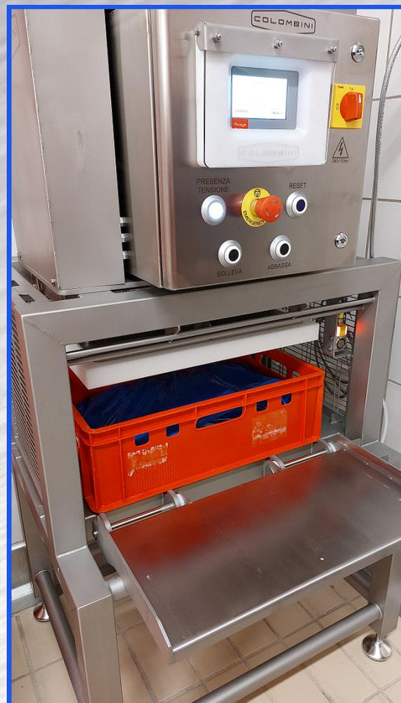
Costruzione completamente in acciaio inox.
