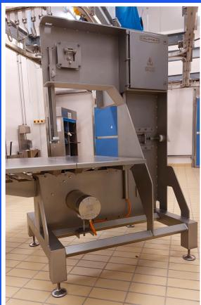
QUADRO ELETTRICO E MOTORE AUTOFRENANTE INOX IP69K
